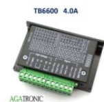
TB6600 Driver moteur pas à pas 4A DC 9~42V 125 DH
