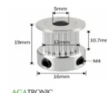
20T W6 B5 Poulie GT2 - courroie 6mm dents 20 axe 5mm 16 DH
