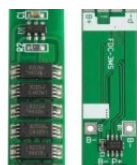
1S 15A BMS chargeur de batteries lithium 1 cellule 25 DH
