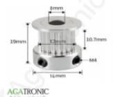
20T W10 B8 Poulie GT2 - courroie 10mm dents 20 axe 5mm 16 DH
