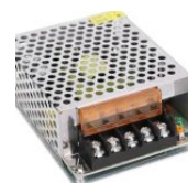
Alimentation à Découpage 60W 24V 2.5A 110 DH
