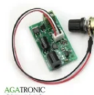
Variateur de vitesse 80W 3A PWM pour moteur DC 70 DH
